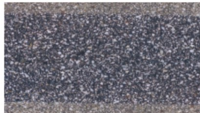
水射流彻底清除标识而不会破坏原有路面，优于其他任何方式
