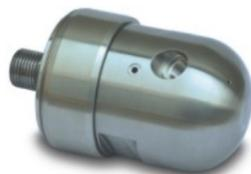
Typhoon (台风)™ 20自旋转喷嘴适用于管道直径为6-10" (15.2-25.4 cm)。它的操作压力可以达到24,000 psi (1,680 bar), 流量可以达到20 gpm (76 lpm), 旋转速度为50-500 rpm。
