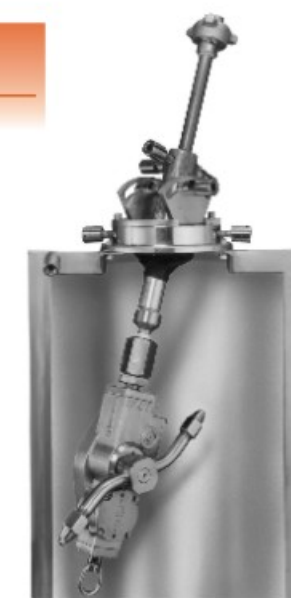
NLB 3750 喷头在水平面旋转，而水射流喷嘴在垂直面旋转。
